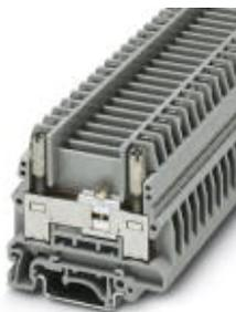
Borne interrump. para circ. medida, con eslabón deslizante, tipo de conexión: Conexión por tornillo, sección: 0,5 mm<sup>2</sup> - 10 mm<sup>2</sup>, AWG: 20 - 10, anchura: 8,2 mm, clase de montaje: NS 35/7,5, NS 35/15, NS 32, color: gris
