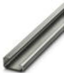
Carril simétrico sin perforar, Perfil G, anchura: 32 mm, altura: 15 mm, según EN 60715, material: Acero, galvanizado, pasivado de capa gruesa, longitud: 2000 mm, color: plateado
