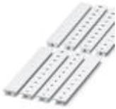
Tira Zack, Tiras, blanco, rotulado, rotulable con: CMS-P1-PLOTTER, rotulación longitudinal: números correlativos de 1 ...10, 11 ...20 etc. hasta 91 ...100, clase de montaje: encajar en ranura para índice alta, para ancho de borne: 8,2 mm, superficie útil: 10,5 x 8,15 mm, Número de índices individuales: 10
