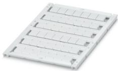
Marcador para bornes, disponible: por esteras, blanco, rotulado según las indicaciones del cliente, clase de montaje: encajar en ranura para índice alta, para ancho de borne: 8,2 mm, superficie útil: 7,6 x 10,5 mm, Número de índices individuales: 42
