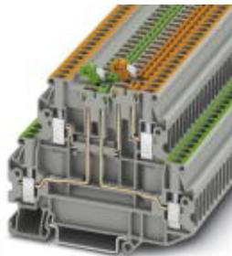
Borne interrumpible por cuchilla, tensión nominal: 400 V, corriente nominal: 16 A, tipo de conexión: Conexión por tornillo, sección: 0,14 mm<sup>2</sup> - 4 mm<sup>2</sup>, AWG: 26 - 12, longitud: 80,1 mm, anchura: 5,2 mm, color: gris, montaje: NS 35/7,5, NS 35/15
