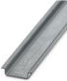
Carril simétrico sin perforar, Perfil estándar, anchura: 35 mm, altura: 7,5 mm, según EN 60715, material: Acero, galvanizado, longitud: 2000 mm, color: plateado
