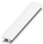
Marcador para bornes, Tiras, blanco, rotulado, rotulable con: CMS-P1-PLOTTER, rotulación longitudinal: U, V, W, N, GND, U, V, W, N, GND, clase de montaje: encajar en ranura para índice alta, para ancho de borne: 6,2 mm, superficie útil: 6,15 x 10,5 mm, Número de índices individuales: 10
