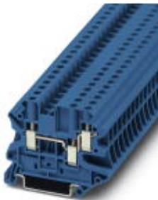
Borne de paso, tensión nominal: 500 V, corriente nominal: 32 A, tipo de conexión: Conexión por tornillo, número de conexiones: 3, sección: 0,14 mm<sup>2</sup> - 6 mm<sup>2</sup>, AWG: 26 - 10, anchura: 6,2 mm, altura: 46,9 mm, color: azul, clase de montaje: NS 35/7,5, NS 35/15
