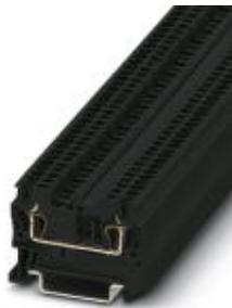
Borne de paso, tensión nominal: 500 V, corriente nominal: 17,5 A, tipo de conexión: Conexión por resorte, número de conexiones: 2, sección: 0,08 mm<sup>2</sup> - 1,5 mm<sup>2</sup>, AWG: 28 - 16, anchura: 4,2 mm, color: negro, clase de montaje: NS 35/7,5, NS 35/15
