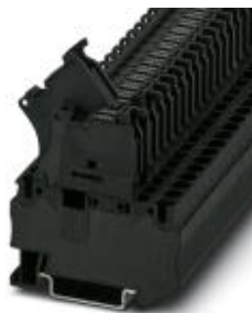
Borne para fusible con palanca, color negro, para cartuchos para fusibles G de 5 x 20 mm, con LED para 250 V AC
