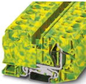
Borne de tierra para carril, tipo de conexión: Conexión por resorte, número de conexiones: 2, sección: 2,5 mm<sup>2</sup> - 35 mm<sup>2</sup>, AWG: 14 - 2, anchura: 16 mm, color: amarillo-verde, clase de montaje: NS 35/7,5, NS 35/15
