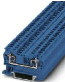
Borne de paso, tensión nominal: 800 V, corriente nominal: 32 A, tipo de conexión: Conexión por resorte, número de conexiones: 2, sección: 0,08 mm<sup>2</sup> - 6 mm<sup>2</sup>, AWG: 28 - 10, anchura: 6,2 mm, color: azul, clase de montaje: NS 35/7,5, NS 35/15
