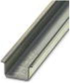
Carril simétrico sin perforar, Perfil estándar, anchura: 35 mm, altura: 15 mm, similar EN 60715, material: Acero, galvanizado, pasivado de capa gruesa, longitud: 2000 mm, color: plateado
