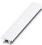
Marcador para bornes, Tiras, blanco, rotulado, rotulable con: CMS-P1-PLOTTER, longitudinal: L1, L2, L3, N, PE, L1, L2, L3, N, PE, clase de montaje: encajar en ranura para índice alta, para ancho de borne: 6,2 mm, superficie útil: 6,15 x 10,5 mm, Número de índices individuales: 10
