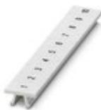
Tira Zack, Tiras, blanco, rotulado, rotulable con: CMS-P1-PLOTTER, rotulación longitudinal: números correlativos de 1 ... 10, 11 ... 20 etc. hasta 491 ... 500, clase de montaje: encajar en ranura para índice alta, para ancho de borne: 6,2 mm, superficie útil: 6,15 x 10,5 mm, Número de índices individuales: 10
