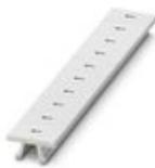
Tira Zack, Tiras, blanco, rotulado, rotulable con: CMS-P1-PLOTTER, rotulación longitudinal: Números iguales 1 o 2 etc. hasta 100, clase de montaje: encajar en ranura para índice alta, para ancho de borne: 6,2 mm, superficie útil: 6,15 x 10,5 mm, Número de índices individuales: 10
