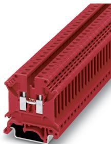
Borne de paso, tensión nominal: 800 V, corriente nominal: 32 A, tipo de conexión: Conexión por tornillo, número de conexiones: 2, sección: 0,2 mm<sup>2</sup> - 6 mm<sup>2</sup>, AWG: 24 - 10, anchura: 6,2 mm, color: rojo, clase de montaje: NS 35/7,5, NS 35/15, NS 32
