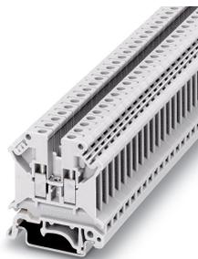
Borne de paso, tensión nominal: 800 V, corriente nominal: 32 A, tipo de conexión: Conexión por tornillo, número de conexiones: 2, sección: 0,2 mm<sup>2</sup> - 6 mm<sup>2</sup>, AWG: 24 - 10, anchura: 6,2 mm, color: blanco, clase de montaje: NS 35/7,5, NS 35/15, NS 32
