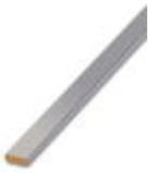
Barra colectora del neutro, anchura: 10 mm, altura: 3 mm, DIN VDE 0611-4: 1991-02, material: Cobre, estañado, longitud: 1000 mm, color: plateado
