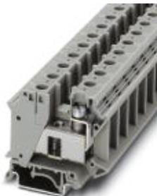
Borne de instalación, Conexión por tornillo, sección: 0,75 mm<sup>2</sup> - 35 mm<sup>2</sup>, AWG: 18 - 2, anchura: 15,2 mm, color: gris, clase de montaje: NS 35/7,5, NS 35/15, NS 32
