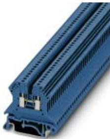
Borne de paso, tensión nominal: 500 V, corriente nominal: 17,5 A, tipo de conexión: Conexión por tornillo, número de conexiones: 2, sección: 0,14 mm<sup>2</sup> - 1,5 mm<sup>2</sup>, AWG: 26 - 16, anchura: 4,2 mm, color: azul, clase de montaje: NS 35/7,5, NS 35/15, NS 32
