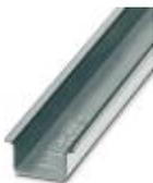
Carril simétrico sin perforar, Perfil estándar, anchura: 35 mm, altura: 15 mm, similar EN 60715, material: Acero, Galvanizado, pasivado blanco, longitud: 2000 mm, color: plateado
