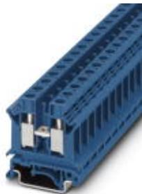
Borne de paso, tensión nominal: 800 V, corriente nominal: 57 A, tipo de conexión: Conexión por tornillo, número de conexiones: 2, sección: 0,5 mm<sup>2</sup> - 16 mm<sup>2</sup>, AWG: 20 - 6, anchura: 10,2 mm, color: azul, clase de montaje: NS 35/7,5, NS 35/15, NS 32
