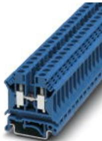
Borne de paso, tensión nominal: 800 V, corriente nominal: 41 A, tipo de conexión: Conexión por tornillo, número de conexiones: 2, sección: 0,2 mm<sup>2</sup> - 10 mm<sup>2</sup>, AWG: 24 - 8, anchura: 8,2 mm, color: azul, clase de montaje: NS 35/7,5, NS 35/15
