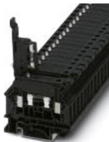
Borne de carril para fusible, tipo de fusible: Vidrio/cerámica/..., número de polos: 1, tipo de conexión: Conexión por tornillo, sección: 0,2 mm<sup>2</sup>- 6 mm<sup>2</sup>, AWG: 24 - 10, corriente nominal: 6,3 A, tensión nominal: 500 V, anchura: 8,2 mm, tipo de fusible: G/5 x 20, clase de montaje: NS 35/7,5, NS 35/15, NS 32, color: negro
