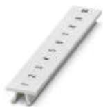
Tira Zack, Tiras, blanco, rotulado, rotulable con: CMS-P1-PLOTTER, rotulación longitudinal: números correlativos de 1 ... 10, 11 ... 20 etc. hasta 491 ... 500, clase de montaje: encajar en ranura para índice alta, para ancho de borne: 6,2 mm, superficie útil: 6,15 x 10,5 mm, Número de índices individuales: 10
