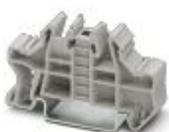
Soporte final de montaje rápido, para carril simétrico NS 35/7,5 o carril simétrico NS 35/15, con posibilidad de marcado, ancho: 9,5 mm, color: gris
