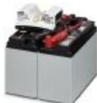
Acumulador de energía, AGM de plomo, tecnología VRLA, 24 V DC, 13 Ah, cambio de batería sin herramienta, detección y comunicación automáticas con QUINT UPS-IQ
