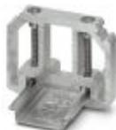
Soporte final, para el apoyo de UKH 50 hasta UKH 240, se desliza sobre el carril NS 35 y se sujeta con 2 tornillos, anchura: 10 mm, color: Aluminio
