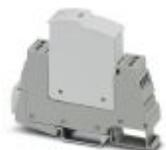
Protección contra sobretensiones de tipo 3, formada por protección enchufable y elemento de base, con indicador de estado e indicación remota integrados para redes de fuente de alimentación monofásicas. Tensión nominal: 24 V AC/DC.
