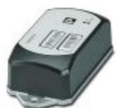
Receptor GNSS y servidor de tiempo NTP (Network Time Protocol) para redes Ethernet, recibe la hora, la fecha y la ubicación mediante GPS, GLONASS o Galileo, gestión basada en web, alimentación mediante PoE (af) o 24 V DC, antena integrada, carcasa IP68
