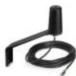
Antena de radiotelefonía móvil multibanda con soporte de montaje para instalar en exteriores, 5 m de cable de antena con conector redondo SMA, apto para LTE/4G
