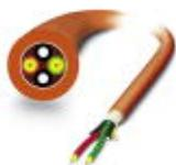
Cable de instalación GOF confeccionable robusto para interiores con elementos de aramida y compensadores de tensión con gran resistencia a la rotura. Elementos individuales de material FRNC altamente flexible. Sin halógenos, resistente al ozono y a los rayos ultravioleta con un revestimiento externo de poliuretano (PUR) muy robusto.
