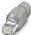
Conector enchufable RJ45, índice de protección: IP20, número de polos: 8, 1 GBit/s, CAT5 (IEC 11801:2002), material: PA, tipo de conexión: Conexión rápida IDC, sección de conexión: AWG 26- 23, salida de cables: recta, color: gris tráfico A RAL 7042
