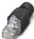
Conector enchufable RJ45, índice de protección: IP20, número de polos: 8, 1 GBit/s, CAT5 (IEC 11801:2002), material: PA, tipo de conexión: Conexión rápida IDC, sección de conexión: AWG 26- 23, salida de cables: recta, color: negro
