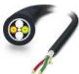
Cable redondo GOF confeccionable muy robusto (sólo cabezas IP 20) para disposición exterior con barrera de vapor integrada, así como una capa de hilo de vidrio anti roedores. Elementos individuales de material FRNC muy flexible. Resistente al ozono y a los rayos ultravioleta con un revestimiento externo de polietileno muy robusto.
