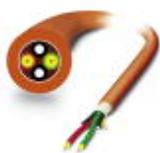
Cable de instalación GOF confeccionable robusto (solo cabezas IP 20) para la disposición en instalaciones y máquinas fijas, elementos de compensación de tracción de aramida, elementos individuales de material FRNC, sin halógenos, resistente al ozono y a los rayos ultravioleta, con un revestimiento externo de poliuretano (PUR)
