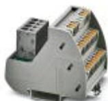
Módulo VARIOFACE con conexión push-in y dos barras colectoras (P1, P2) para distribución de potencial, para el montaje sobre carriles simétricos NS 35. Ancho de módulo: 57,1 mm
