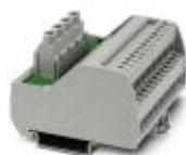
Módulo VARIOFACE con dos barras colectoras (P1, P2) para distribución de potencial, para el montaje sobre carriles simétricos NS 35. Anchura del módulo: 70,4 mm
