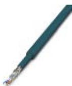
Cable CAT5-SF/UTP (J-02YS(ST)C HP 2 x 2 x 24 AWG), cable de instalación robusto, 2 x 2 x 0,22 mm<sup>2</sup>, conductor rígido, apantallado, envoltura exterior: Diámetro 7,8 mm, envoltura interior: Diámetro 5,75 mm ± 0,15 mm
