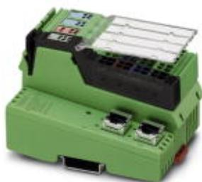
Inline, Acoplador de bus, EtherNet/IP™, Hembra RJ45, Entradas digitales: 8, 24 V DC, técnica de conexión: 3 conductores, Salidas digitales: 4, 24 V DC, 500 mA, técnica de conexión: 3 conductores, velocidad de transmisión en el bus local: 500 kBit/s / 2 MBit/s, índice de protección: IP20, incluidos conectores Inline y campos de rotulación
