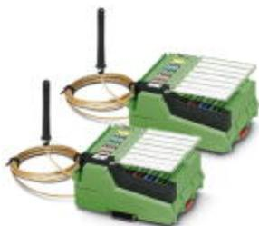
Juego Wireless MUX, dos módulos con 16 entradas y salidas digitales cada uno y 2 entradas y salidas analógicas (0 ... 20 mA, 0 ... 10 V), incl. antenas omnidireccionales con cable de 1,5 m
