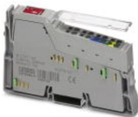
Inline, Módulo de salida digital, Salidas digitales: 1, 230 V AC, 500 mA, técnica de conexión: 3 conductores, velocidad de transmisión en el bus local: 500 kBit/s, índice de protección: IP20, incluidos Inline conector y superficie de rotulación
