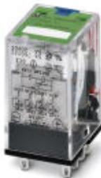
Relés industriales enchufables con contactos de potencia y dorado duro adicional, 4 contactos conmutados, tecla de comprobación, LED de estado, diodo de rueda libre, indicación mecánica de la posición de conmutación, polaridad A1-, A2+, tensión de bobina: 24 V DC
