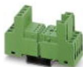
Zócalo de relé PR2-B, para relés industriales REL-IR con 2 ó 4 contactos conmutados, ejecución de 2/2 pisos, conexiones por tornillo, posibilidad de enchufe para módulos de entrada/antiparasitarios, para el montaje sobre NS 35/7,5
