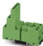
Zócalo de relé PR2-B, para relés industriales REL-IR con 2 ó 4 contactos conmutados, ejecución de 1/3 pisos, conexiones por tornillo, posibilidad de enchufe para módulos de entrada/antiparasitarios, para el montaje sobre NS 35/7,5
