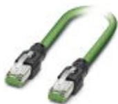
Cable de parcheo PROFINET, apantallado, cuadrete en estrella, AWG 22 flexible (7 hilos), verde, conector RJ45/IP20, recto, sobre conector macho RJ45/IP20, recto, longitud: 2 m
