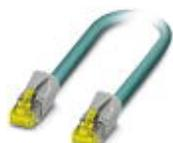
Cable de parcheo, CAT6<sub>A</sub>, 4 pares, apantallado, conexión no cruzada (Line), confeccionado a ambos lados con conectores enchufables RJ45/IP20, material de la envoltura exterior: PUR, longitud: 3,0 m
