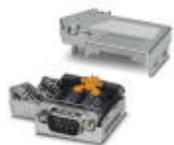
Conector D-SUB, 9 polos, macho, entrada de cables bajo 35°, sistema de bus: PROFIBUS DP hasta 12 Mbit/s con conector hembra Pg-D-SUB para la conexión de un aparato de programación, resistencia terminal conectable a través de conmutador deslizante, ocupación de pins: 3, 5, 6, 8; bornes de conexión por tornillo
