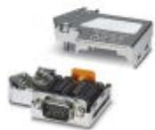
Conector D-SUB, 9 polos, macho, entrada de cables bajo 35°, sistema de bus: PROFIBUS DP hasta 12 Mbits/s, resistencia terminal conectable a través de conmutador deslizante, ocupación de pins: 3, 5, 6, 8; bornes de conexión por tornillo
