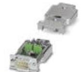
Conector D-SUB, 9 polos, macho, ejecución axial con dos entradas de cables, sistema de bus: PROFIBUS DP hasta 12 Mbits/s, resistencia terminal conectable a través de conmutador deslizante, ocupación de pins: 3, 5, 6, 8; bornes de conexión por tornillo
