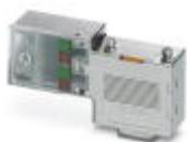
Conector D-SUB, 9 polos, macho, entrada de cables bajo 90°, sistema de bus: PROFIBUS DP hasta 12 Mbits/s, resistencia terminal conectable a través de conmutador deslizante, ocupación de pins: 3, 5, 6, 8; bornes de conexión por tornillo
