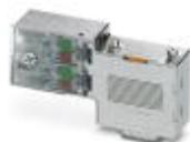
Conector D-SUB, 9 polos, macho, entrada de cables bajo 90°, sistema de bus: PROFIBUS DP hasta 12 Mbits/s, resistencia terminal conectable a través de conmutador deslizante, ocupación de pins: 3, 5, 6, 8; conexión de bornes IDC
