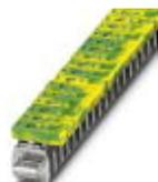
Borne de conexión, tipo de conexión: Conexión por tornillo, corriente de carga: 41 A, sección: 0,5 mm<sup>2</sup> - 6 mm<sup>2</sup>, anchura: 7 mm, color: amarillo-verde
