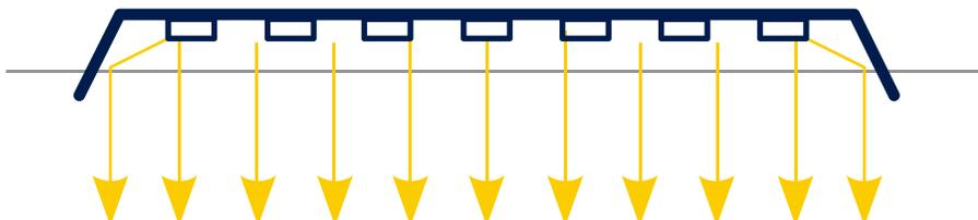
En un panel LED retroiluminado o backlight, los chips LED se sitúan en una placa horizontal detrás del panel, emitiendo luz verticalmente a través de un difusor, logrando así una iluminación más efectiva y directa. Por sus características constructivas estos paneles no adquieren tonalidad amarilla con el paso del tiempo.
