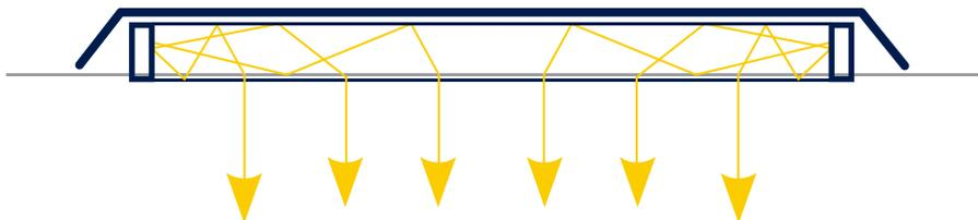
Están conformados por una hilera de LEDs dispuestos en el borde del panel, emitiendo luz de manera horizontal sobre una placa de guía de luz, la que canaliza la luz hacia abajo a través de un difusor.
