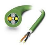
Cable de fibra PROFINET PCF, dúplex  $200 \mu m/230 \mu m$ , para la disposición en instalaciones y máquinas fijas, tipo B, revestimiento externo de PVC, material por metros sin conector
