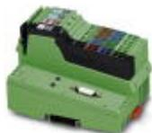
Inline, Acoplador de bus, Modbus/RTU, Conector hembra D-SUB-9, Entradas digitales: 8, 24 V DC, técnica de conexión: 3 conductores, Salidas digitales: 4, 24 V DC, 500 mA, técnica de conexión: 3 conductores, velocidad de transmisión en el bus local: 500 kBit/s / 2 MBit/s, índice de protección: IP20, incluidos conectores Inline y campos de rotulación
