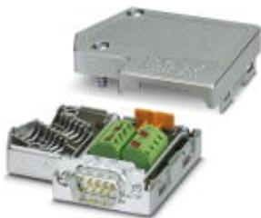
Conector D-SUB, 9 polos, macho, dos entradas de cable en 35°, sistema de bus: Para acoplador de bus Inline Modbus RTU/ASCII, resistencia de cierre conectable a través de conmutador deslizante, ocupación de pines: 3, 5, 6, 8; bornes de conexión por tornillo
