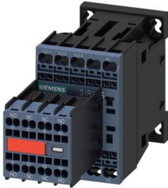
Contactor de potencia, AC-3 12 A, 5,5 kW/400 V 2 NA + 2 NC, 24 V DC 3 polos, tamaño S00 conexión por resorte bloque de contactos auxiliares no desmontable
