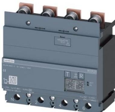
Aparato de protección de corriente diferencial RCD520 Basic RCD Tipo A montaje abajo Corriente nominal de defecto 0,03...5 A a 50/60 Hz TV ajustable 0...3000 ms 4 polos In=250 A Ue=100-480V Accesorio para: 3VA1
