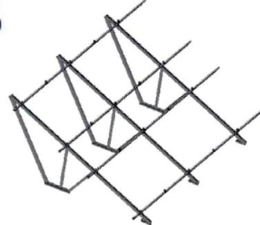
Sujeción de perfil correa mediante grapa de correa deslizante.
