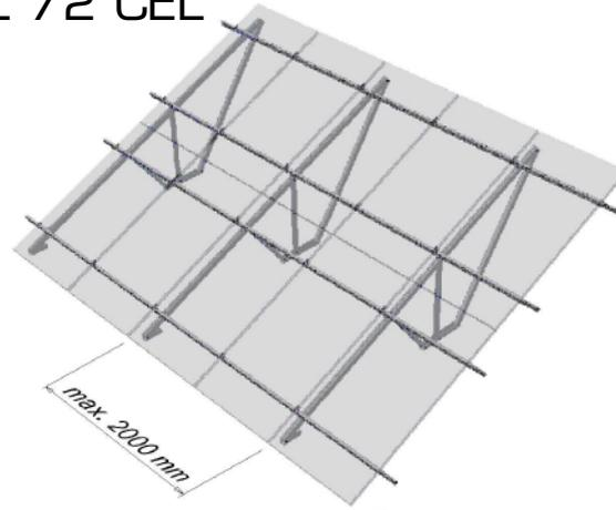
**2** Ensamblar componentes 1 y 2 del pórtico.
