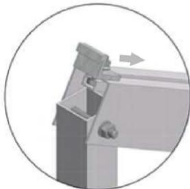
Insertar por la guía del pórtico las grapas de sujeción del perfil correa. Unión mediante tornillo de cabeza hexagonal y tuerca de collar biselado sin realizar par de apriete. Permitir su movimiento deslizable dentro del carril guía.
