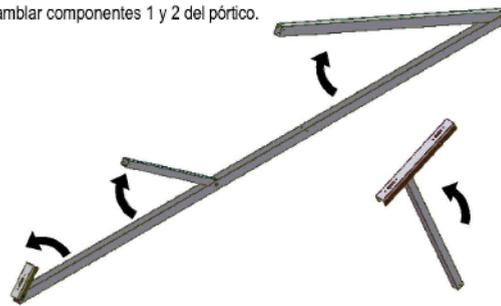
**3** Unión atornillada de los componentes con tornillo de cabeza hexagonal (Lg=60 mm) y tuerca de collar biselado.
