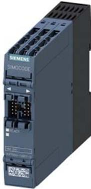
Módulo multifunción, 4 entradas y 2 salidas de relé, tensión de entrada 24 V DC, salidas de relé monoestables, detección analógica de corrientes de defecto, con transformador de corriente diferencial 3UL23 Conexión de sensor de temperatura PT100/PT1000/KTY/NTC, máximo 1 módulo multifunción por unidad base SIMOCODE pro S
