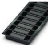
Carcasa base placa de circuito impreso, número de polos: 5, paso: 5,08 mm, color: negro, superficie contactos: Estaño, disposición de pines: Disposición de pines lineal, longitud del pin [P]: 2,9 mm, Encontrará más información para el usuario y recomendaciones de diseño sobre la tecnología Through Hole Reflow en: [Downloads](#)
