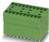
Carcasa base placa de circuito impreso, corriente nominal: 8 A, tensión de dimensionamiento (III/2): 160 V, sección nominal: 1,5 mm<sup>2</sup>, número de polos: 5, paso: 3,81 mm, color: verde, superficie contactos: Estaño, montaje: Soldadura por ola, disposición de pines: Disposición de pines lineal, longitud del pin [P]: 3,4 mm, En el caso de una combinación con partes enchufables MCV, debe utilizarse un conector MCVW y un conector MCVR, respectivamente.
