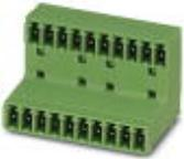
Carcasa base placa de circuito impreso, corriente nominal: 8 A, tensión de dimensionamiento (III/2): 160 V, sección nominal: 1,5 mm<sup>2</sup>, número de polos: 5, paso: 3,81 mm, color: verde, superficie contactos: Estaño, montaje: Soldadura por ola, disposición de pines: Disposición de pines lineal, longitud del pin [P]: 3,5 mm, En el caso de una combinación con partes enchufables MCV, debe utilizarse un conector MCVW y un conector MCVR, respectivamente.
