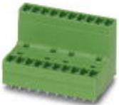
Carcasa base placa de circuito impreso, corriente nominal: 8 A, tensión de dimensionamiento (III/2): 160 V, sección nominal: 1,5 mm<sup>2</sup>, número de polos: 5, paso: 3,81 mm, color: verde, superficie contactos: Estaño, montaje: Soldadura por ola, disposición de pines: Disposición de pines lineal, longitud del pin [P]: 3,4 mm, En el caso de una combinación con partes enchufables MCV, debe utilizarse un conector MCVW y un conector MCVR, respectivamente.
