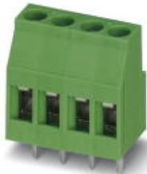
Borne para placa de circuito impreso, corriente nominal: 24 A, tensión de dimensionamiento (III/2): 400 V, sección nominal: 2,5 mm<sup>2</sup>, paso: 5,08 mm, número de polos: 8, tipo de conexión: Conexión por tornillo con cápsula de tracción, montaje: Soldadura por ola, dirección de conexión conductor/placa de circuito impreso: 0 °, color: verde, Disposición de pines: Disposición de pines lineal, Longitud del pin [P]: 5 mm. ¡El artículo puede alinearse con distintos números de polos!
