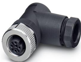
Conector, Universal, 5-polos, Hembra de conexión acodado M12, Codificación: A, Conexión por tornillo, material de moleteado: Fundición inyectada de cinc, niquelada, prensaestopas Pg9, diámetro exterior del cable 6 mm ... 8 mm
