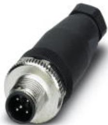
Conector, Universal, 5-polos, Conector macho recta M12, Codificación: A, Conexión por tornillo, material de moleteado: Fundición inyectada de cinc, niquelada, prensaestopas Pg7, diámetro exterior del cable 4 mm ... 6 mm
