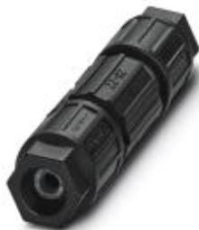
Empalmadores de cables, Conexión QUICKON, número de polos: 4, 0,14 mm<sup>2</sup> ... 0,34 mm<sup>2</sup>, 125 V, 5 A, negro, rango de diámetro de cable: 3,5 mm ... 6 mm, Conexión rápida QUICKON
