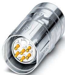
Conector enchuf. para cables, CA, recto, apantallado: sí, Bloqueo SPEEDCON, M23, N° de polos: 6, tipo de contacto: Pin, Conexión por soldadura, rango de diámetro de cable: 6 mm ... 10 mm, codificación:N
