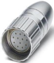
Conector enchufable para cables, RC, recto, apantallado: sí, Bloqueo por tornillo, M23, N° de polos: 6, tipo de contacto: Hembra, Conexión por soldadura, rango de diámetro de cable: 6,5 mm ... 7,5 mm
