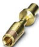
Contacto engastado, mecanizado, Contacto individual, diámetro de contacto: 3,6 mm, margen para engaste: 2,5 mm<sup>2</sup> ... 4 mm<sup>2</sup>
