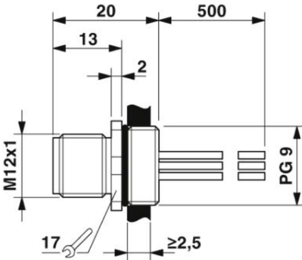
Macho de montaje incorp. M12, posicionable
