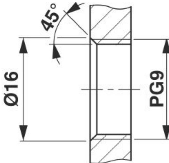
Abertura de carcasa para rosca de fijación Pg9, pared de montaje con rosca
