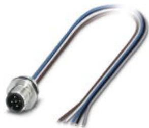
Conector enchufable de montaje incorporado para sensores/actuadores, 5 polos, M12, codificado A, montaje paredes delanteras/montaje atornillado con rosca Pg9, hilo trenzado TPE de 0,5 m, 5 x 0,34 mm<sup>2</sup>, ejecución en acero inoxidable
