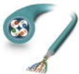
Cable de red, Ethernet CAT5 (1 GBit/s), 8-polos, PUR sin halógenos, azul agua RAL 5021, apantallado, extremo de cable libre, a extremo de cable libre, longitud de cable: Libre entrada (0,5 ... 400 m)
