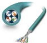
Cable de red, Ethernet CAT6<sub>A</sub> (10 GBit/s), 8-polos, PUR sin halógenos, azul agua RAL 5021, apantallado, extremo de cable libre, a extremo de cable libre, longitud de cable: Libre entrada (0,5 ... 400 m)
