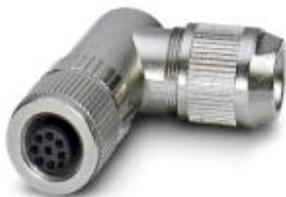
Conector para sistema de bus, Ethernet CAT5 (1 GBit/s), 8-polos, apantallado, Hembra de conexión acodado M12, Codificación: A, Conexión por desplaz. de aislamiento, material de moleteado: Latón, niquelado, diámetro exterior del cable 4 mm ... 8 mm
