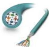
Cable de red, Ethernet CAT5 (1 GBit/s), 8-polos, PUR sin halógenos, azul agua RAL 5021, apantallado, extremo de cable libre, a extremo de cable libre, longitud de cable: Libre entrada (0,5 ... 400 m), para cadenas de arrastre
