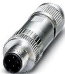
Conector para sistema de bus, Ethernet CAT5 (100 MBit/s), 4-polos, apantallado, Conector macho recta M12, Codificación: D, Conexión por desplaz. de aislamiento, material de moleteado: Latón, niquelado, diámetro exterior del cable 4 mm ... 8 mm
