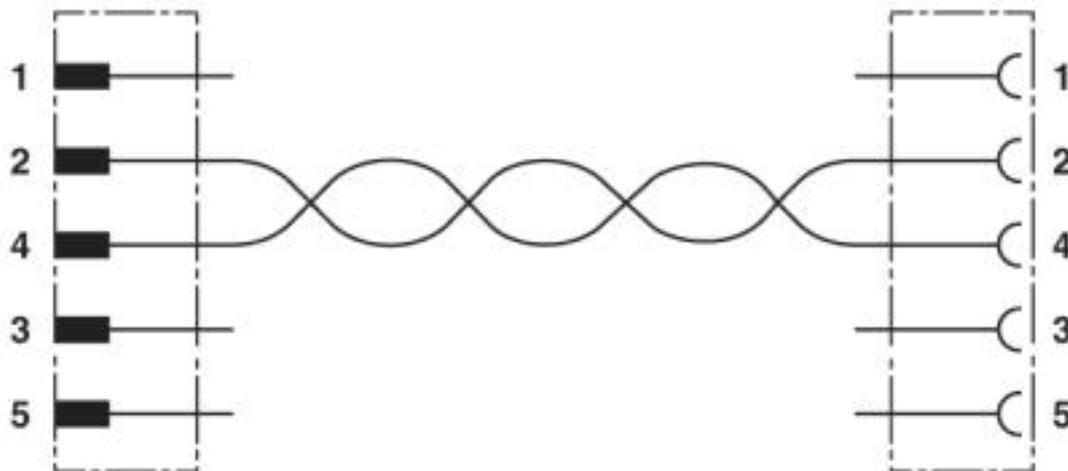
Ocupación de contactos del conector macho M12 y del conector hembra M12
